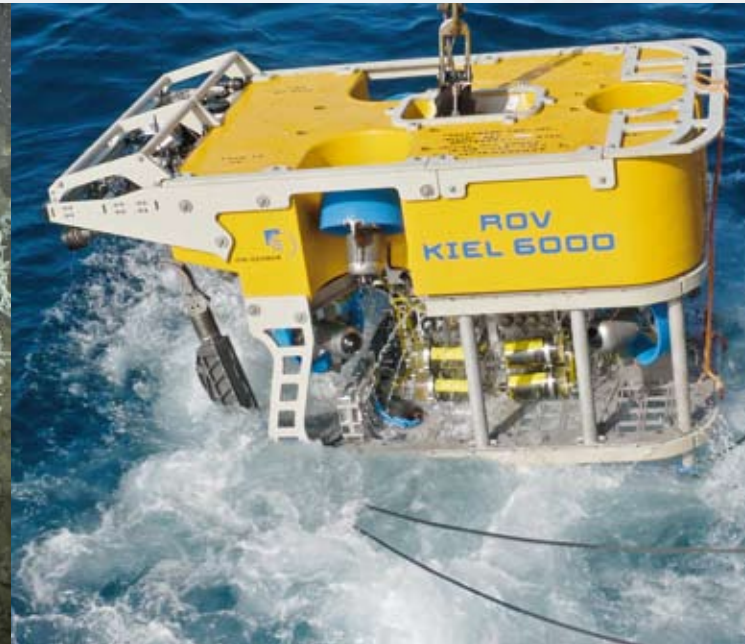
Tiefseetest des ferngesteuerten Tauchroboters »ROV Kiel 6000« vor der Küste von Neuseeland.
